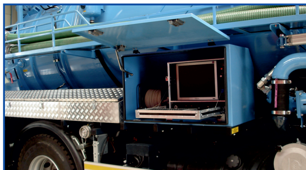
Przykład zamontowania kamery w samochodzie ssaco-płuczającym
