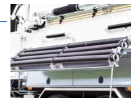
Odkładane panele do transportu rur ssących
