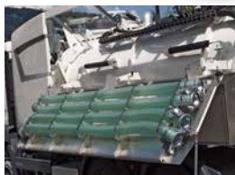
Panele do transportu rur, odkładane, sterowane hydraulicznie z pilota zdalnego sterowania
