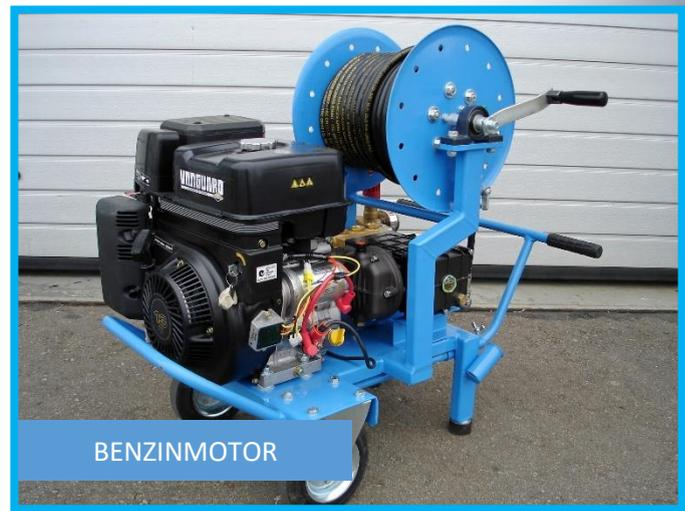
Das Gerät wurde mit einer zuverlässigen Hochdruckpumpe des renommierten europäischen Herstellers UDOR aus Italien ausgestattet. Die Pumpe mit Keramikkolben, dank derer es möglich ist, mit heißem Wasser mit dem Gerät zu arbeiten. Es kann auch von einer Person über die Bedienkonsole bedient werden.
