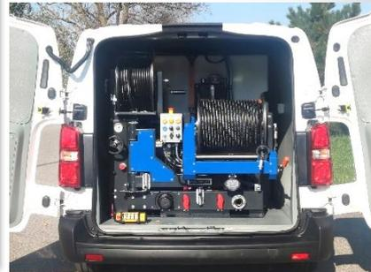
Das Hochdruckgerät ANAKONDA ist für den Einbau in einen Mercedes-Benz Vito und andere VANS konzipiert. Es kann auch auf handelsübliche 1- und 2-Achs-Transportanhänger montiert werden. Überall dort, wo große Reinigungswagen nicht erreichbar sind, ist VIPER perfekt.
