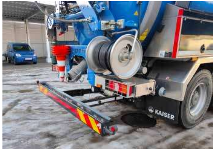
Tylna belka przeciwnajazdowa jest automatycznie chowana w momencie podnoszenia i opróżniania zbiornika, co zapobiega zalewaniu elementu nieczystościami.
