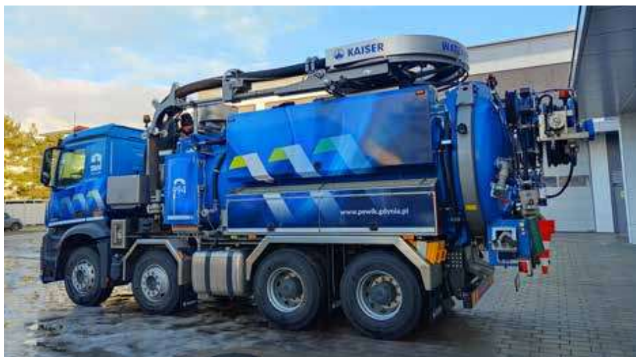
Czteroosiowy Mercedes-Benz Arocs 3258 z zabudową Kaiser AquaStar IV robi wrażenie swoją solidną i zwartą sylwetką. Pojazd jest zwrotny i dobrze radzi sobie w terenie.
