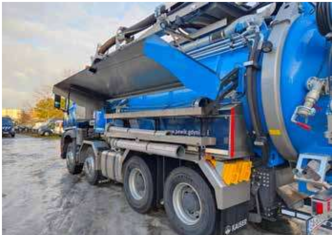
Przedłużki węży ssawnych są przechowywane na półkach opuszczanych hydraulicznie i zabezpieczonych jednocześnie pokrywą podieraną sprężynami gazowymi.
