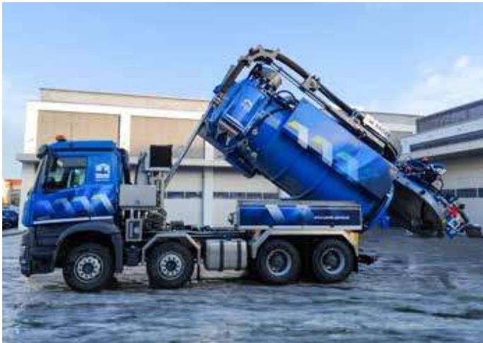
Opróżnianie zbiornika na nieczystości odbywa się w sposób grawitacyjny. Wszystkie konieczne czynności związane z czyszczeniem pojazdu po zakończeniu pracy zajmują maksymalnie pół godziny.
