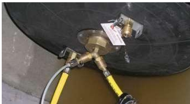
Próba szczelności z użyciem sprężonego powietrza
